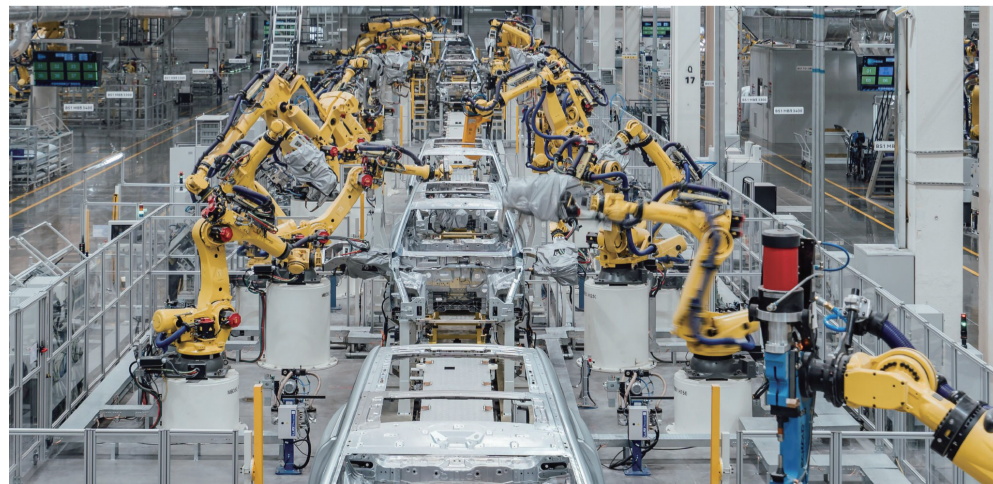
赛力斯汽车超级工厂焊装车间生产线
