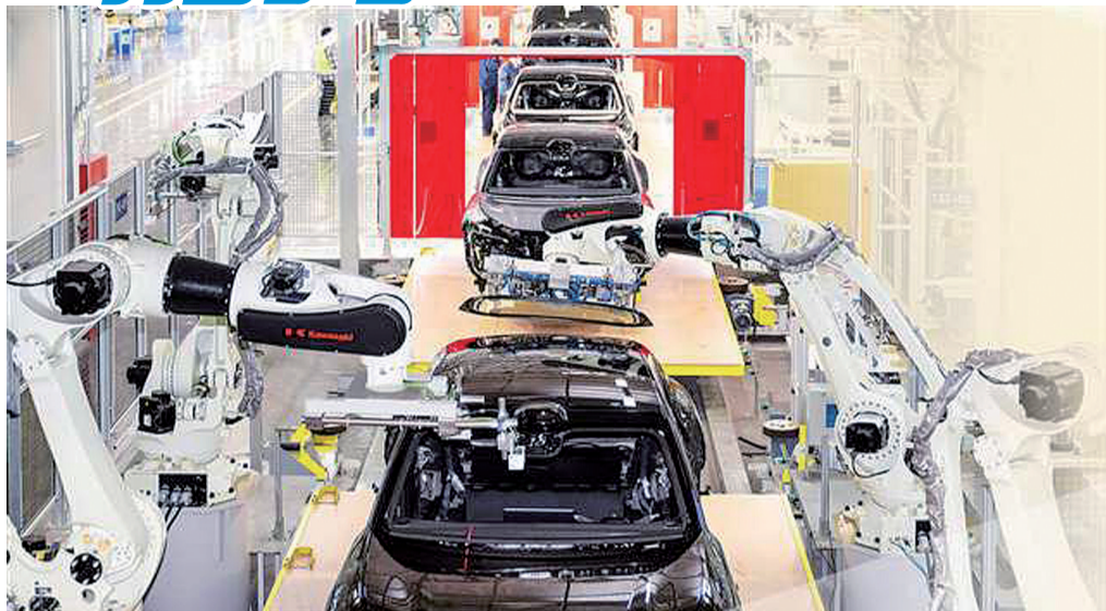
位于渝北区的长安数智工厂，全自动装配机器人和视觉检测机器人协作实现自动化装配。(资料照片)
