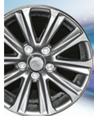
两江新区明月湖实验室,半固态注射成型镁合金轮毂样品
