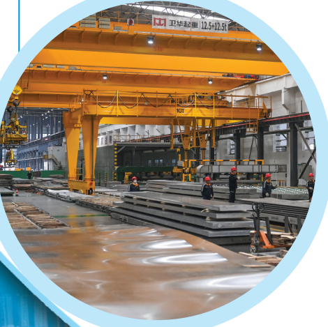
九龙坡区西南铝，工人正在吊运为国产大飞机C919配套的铝合金厚板。
