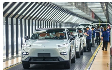
工作人员在灯棚检测线上对车身漆面质量等进行检查
